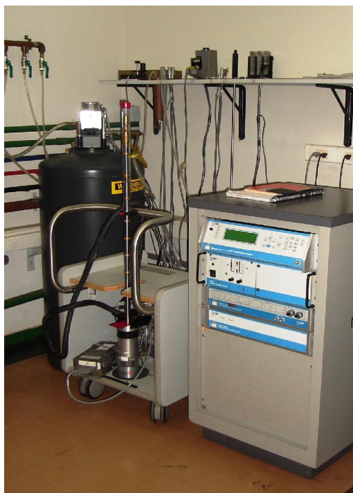
Figura 2.1: O criostato do PPMS da Quantum Design utilizado para medidas de transporte
