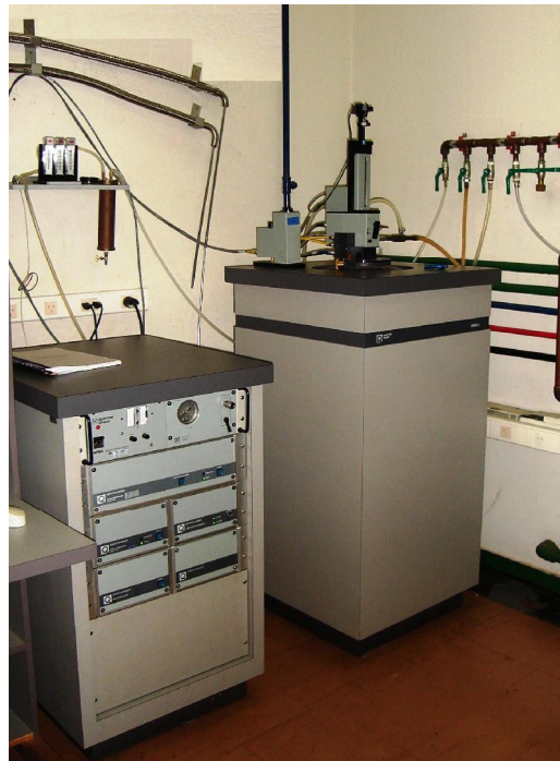
Figura 2.14: Vista do magnetômetro SQUID utilizado nas medidas de magnetização em função da posição da amostra.
