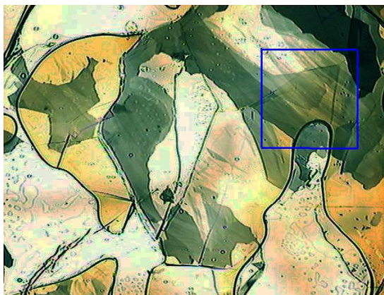
Figura 3.6: Microscopia óptica de uma amostra com poucas camadas de grafeno de uma amostra de grafite submetida à luz infravermelha. No destaque em azul, percebe-se a transparência entra camadas de grafeno.
