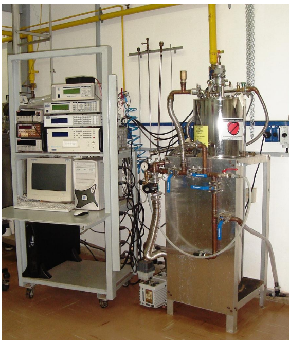
Figura 2.3: O criostato da Janis Research utilizado para medidas de transporte.
