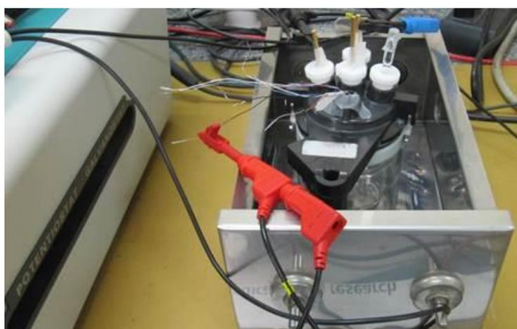
**Figura 5.35:** Célula eletroquímica acoplada ao potenciostato.
