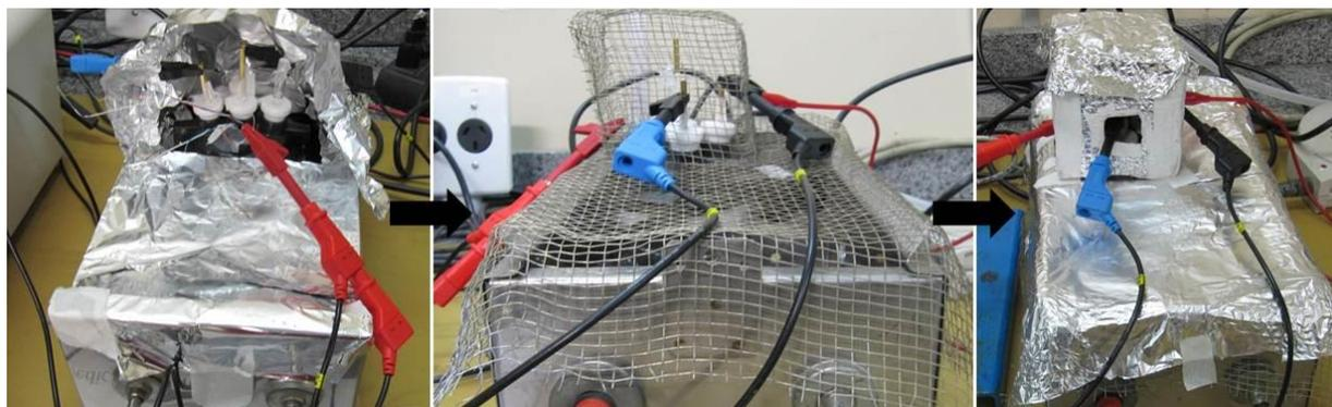
**Figura 5.36:** Evolução das gaiolas de *Faraday* implementadas durante o processo de caracterização.
