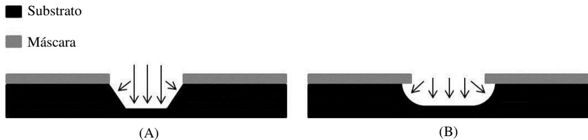
**Figura 2.1:** Processos de corrosão. A magnitude das setas são proporcionais às taxas de corrosão. (A) Corrosão anisotrópica; (B) Corrosão isotrópica.
