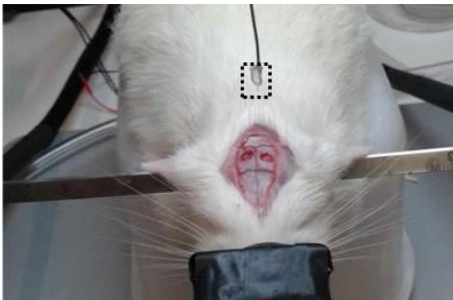
**Figura 5.41:** Teste mecânico de uma sonda neural (destacado) em cadáver de rato.
