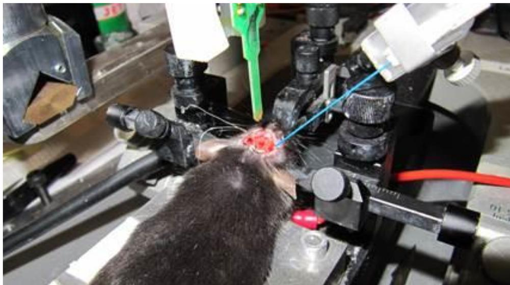
**Figura 5.43:** Experimento de optogenética em camundongo com sonda neural comercial (NeuroNexus).
