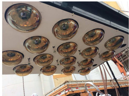
(b) Tampa superior com as fotomultiplicadoras do topo do Alvo.
