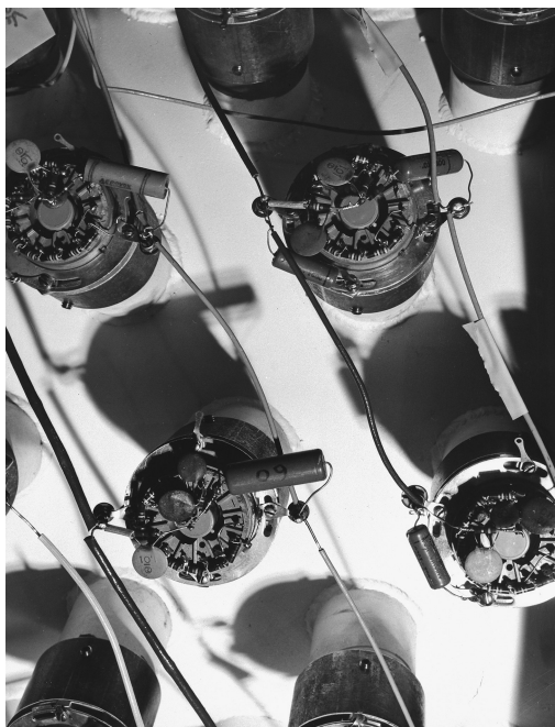
Figura 3 – Detalhe da ligação das fotomultiplicadoras do detector Herr Auge (7).
