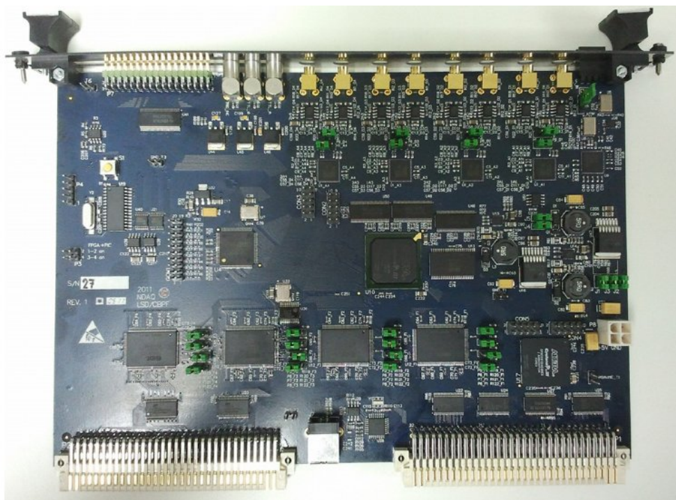
Figura 38 – Módulo utilizado na eletrônica de múons: o NDAQ.
