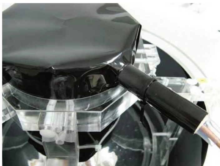
Figura 59 – Solução encontrada para eliminar o Light Noise no Near Detector : as bases das PMTs são envolvidas em uma folha plástica preta.- Extraído da referência 52.
