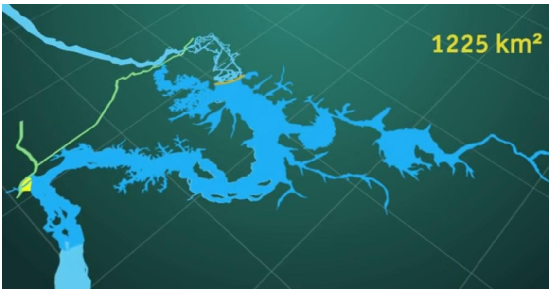
Imagem 2: Área de alagamento original – UHE de Kararaô
