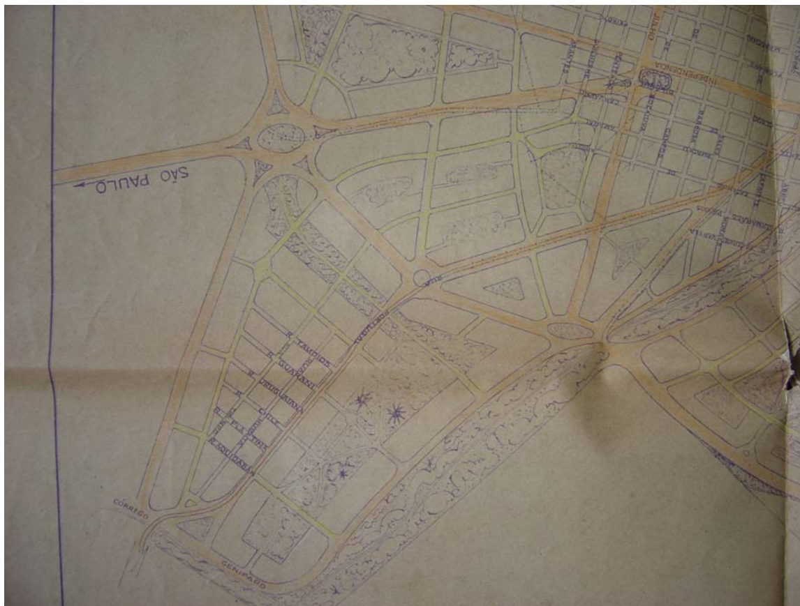
Detalhe do desenho urbanístico das áreas de expansão existentes no Esquema do Plano Diretor de Ribeirão Preto elaborado por José de Oliveira Reis em 1945. No canto superior direito da imagem aparece o sistema reticulado em quadriculas que define o traçado da cidade; Nas áreas em expansão, além do rompimento espacial em relação à quadricula, existe a incorporação de áreas verdes internas e ao longo das “super quadras” que o engenheiro mencionou na palestra. Fonte: Plano Diretor de Ribeirão Preto. Fundo José de Oliveira Reis – Arquivo Público e Histórico de Ribeirão Preto.
