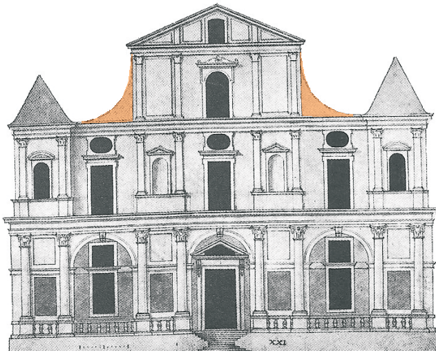
Figura 302 A: Fechamento do telhado da nave lateral.
