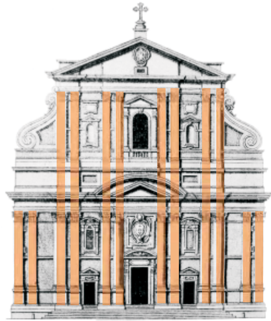
Figura 307 B: Della Porta - Colunas e pilastras aos pares
