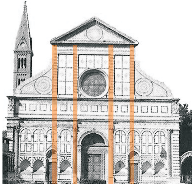
Figura 299 B: Pilastras alinhadas no térreo e no superior.
