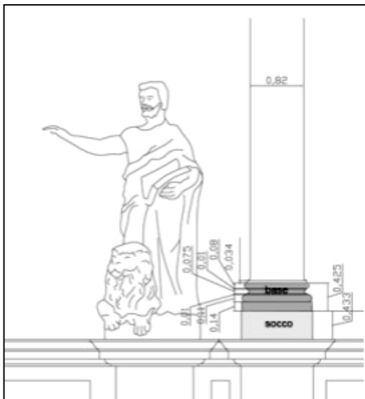
Figura 42: Medidas reais da pilastra de Ordem Coríntia da fachada da Catedral Nossa Senhora da Conceição de Campinas.
