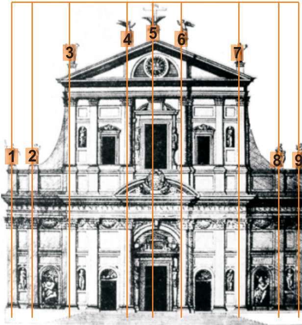
Figura 306 A: Vignola - Nove esculturas que fazem o fechamento das pilastras no ático.
