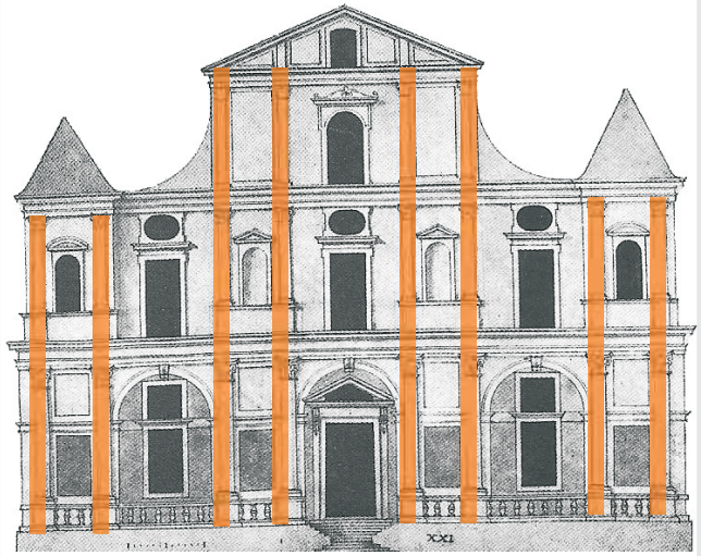
Figura 302 B: Pilastras alinhadas no térreo e no superior.
