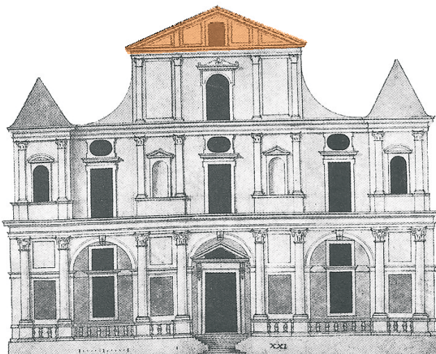
Figura 302 C: Frontão na largura da nave central.
