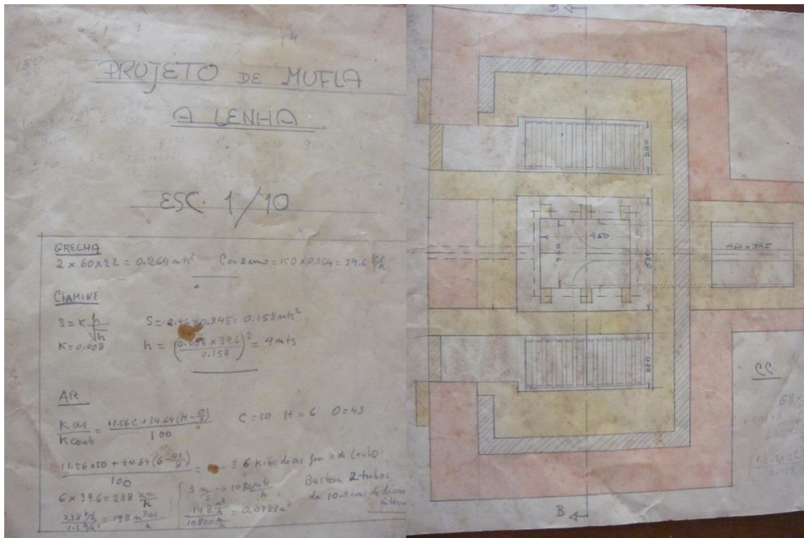
Imagens 100 e 101 – Projeto de mufla a lenha, com desenho e execução de Carlos Prado, no sítio de Tamboré, na década de 1940. O forno era utilizado para fazer peças em cerâmica, que decoravam a porta dos armários da casa de sua mãe no Ibirapuera.
