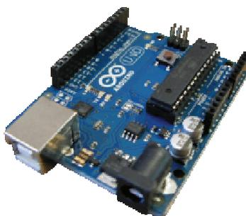
Figura 7: placa Arduino
