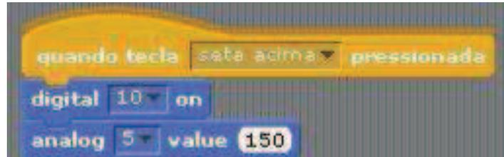
Figura 25: Programação de acionamento de um motor através do teclado
