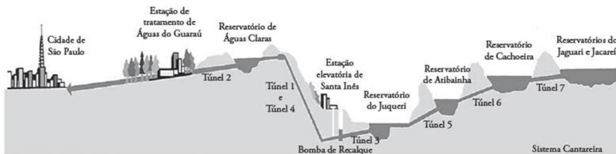
Figura 3: Perfil esquemático do Sistema Produtor de Água Cantareira
