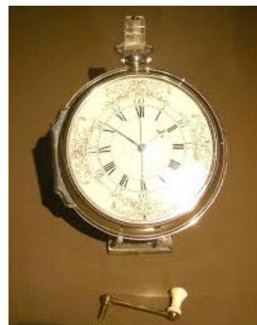
Quarto Cronômetro Marítimo de Harrison. Fonte: Wikimedia Commons
