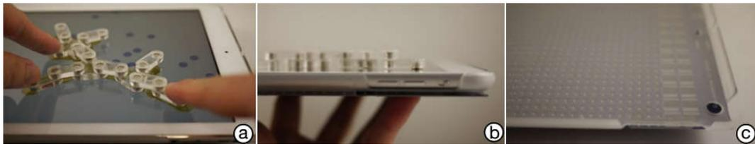
Figura 2.7 - GaussBricks: Sistema de construção de blocos magnéticos, (a) GaussBricks sendo utilizado na construção interativa sobre (b) dispositivos móveis e (c) rede de sensores magnéticos.
