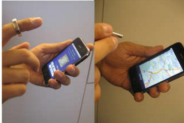
Figura 2.5 - MagiTact: Usuário interagindo com o dispositivo móvel pelos ímãs.
