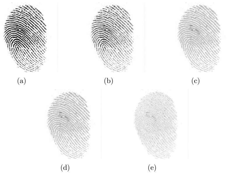
Figura 4.10: Exemplo de aplicação do mapeamento da Equação 4.2 para uma mesma escala \sigma = 20 e diferentes números de iterações: (a) imagem original, (b) resultado utilizando número de iterações k = 1 , (c) k = 5 , (d) k = 10 e (e) k = 15 .
