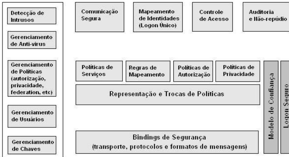
Figura 4.2: Componentes do modelo de segurança da grade. Inspirado em [OGSA, 2002].
