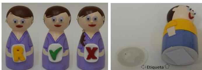
**Figura 5.13.** À esquerda, bonecos para gerenciar a escolha dos estados afetivos no TangiSAM. À direita, Etiquetas RFID posicionadas na parte inferior de cada boneco do TangiSAM.
