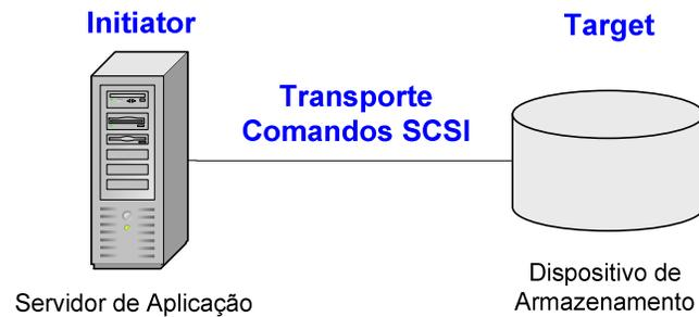
**Figura 7** – Modelo de conexão SCSI
