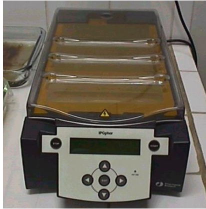
Figura 3.6. Aparelho IPGphor de focalização isoelétrica, correspondente à 1ª dimensão da eletroforese 2D. Nesta etapa ocorreu a focalização isoelétrica em uma gama de pH de 4,0 a 7,0. Posteriormente as amostras foram submetidas à segunda etapa da eletroforese 2D.
