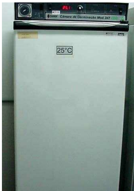
Fig. 1.4 Câmara climática de germinação modelo Fanen 387 utilizada para o desenvolvimento de imaturos de dípteros.
