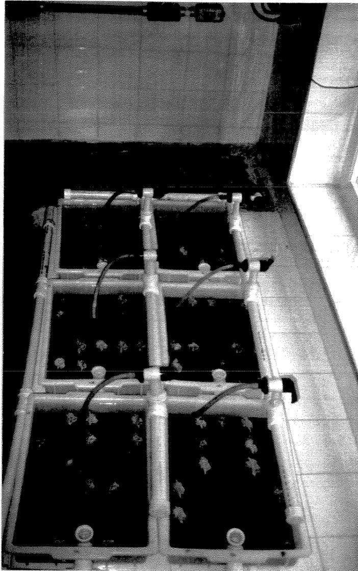
Fig 3 - Sistema de bandejas, com água do mar circulante, utilizado nos experimentos de laboratório.
