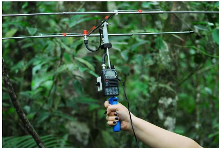
Figura 5: Os radio-receptores (modelo Yaesu VR500, Wagener Telemetrieanlagen, Alemanha) usados na telemetria em campo eram compactos e possuíam uma antena H acoplada, facilitando o deslocamento dentro da mata. Foto: Marco A. R. Mello.
