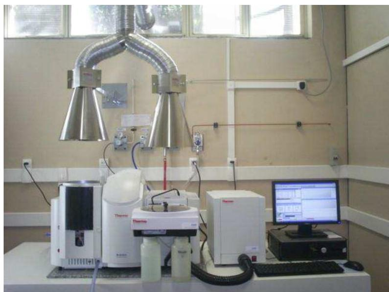
Figura 6: Espectrofotômetro de absorção atômica.
