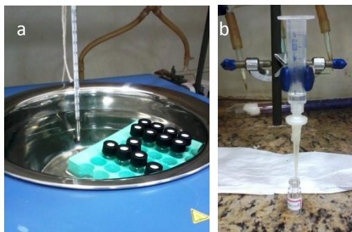
Figura 1 - Etapas da reação de derivatização (a) Amostras em banho-maria, (b) processo de filtração em microfiltro.
