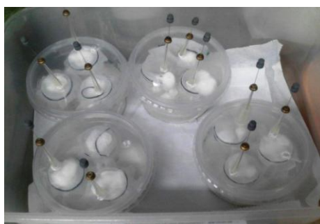
Figura 14 - Fibras para extração de voláteis acopladas os recipientes com os tratamentos.
