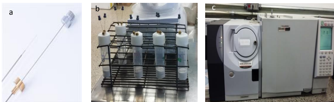
Figura 13 - (a) Fibra para adsorção de possíveis voláteis; (b) tubos com as fibras inseridas; (c) GC-MS; aparelho utilizado para a análise das fibras.
