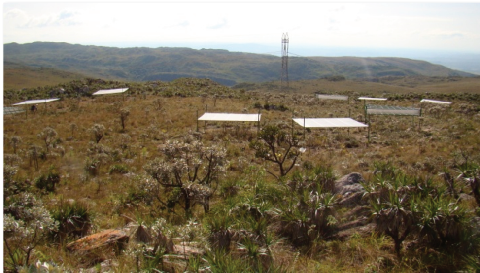
Figura 1. Experimento de exclusão de água da chuva em vegetação de campo rupestre no Parque Nacional da Serra da Canastra. Parcelas com o telhado coberto representam as parcelas para exclusão de água da chuva e aquelas com o telhado aberto representam as parcelas controle.
