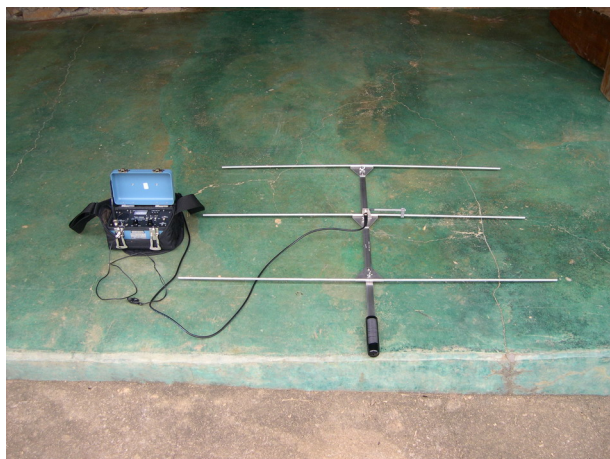
Conjunto usado para radiotelemetria: receptor TRX-1000S (Wildlife Materials), antena (Yagi 3 elementos), cabos, bolsa e fone de ouvido.
