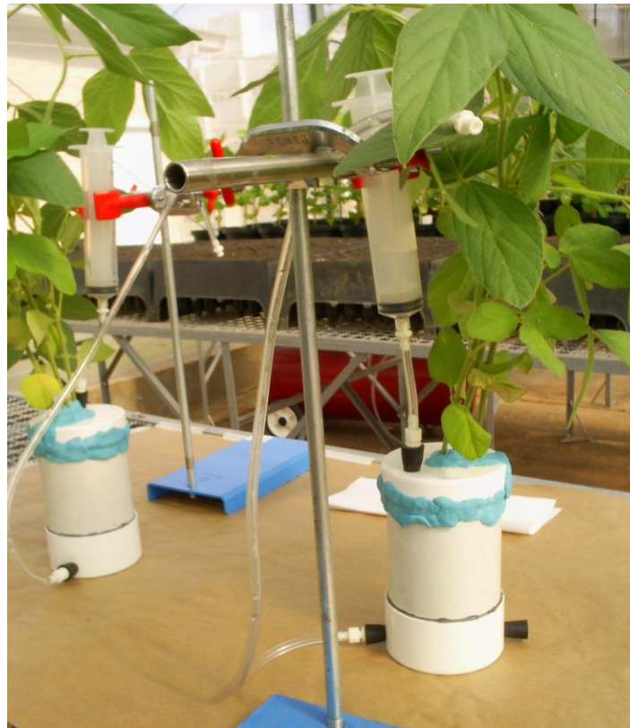
Figura 1: Sistema de incubação com 15 N 2 em vasos Qubit® com o sistema radicular de três plantas em cada vaso. A seringa permanece conectada à porção superior do vaso após injeção do 15 N 2 até que o sistema seja desmontado. A mangueirinha na porção inferior contém água deslocada pela entrada do 15 N 2 . A água impede que haja entrada de 14 N do meio externo.
