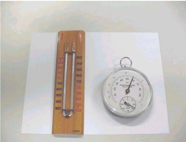
Figura 5. Termômetro (esquerda) modelo MM 5202- Incoterm® e higrômetro (direita) modelo 4463, Stäcker & Olms®, utilizados para obtenção de parâmetros climáticos no campo.
