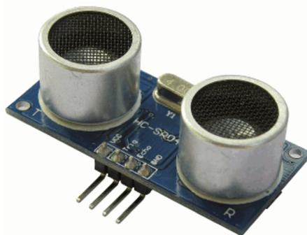
Figura 3 – Sensor ultrassônico HC-SR04 (CYTRON TECHNOLOGIES SDN. BHD., 2013), utilizado no módulo do GuitarAMI com as funções de medir a distância entre o instrumentista e o violão, além de possibilitar a utilização de gestos livres para geração de informação de controle.
