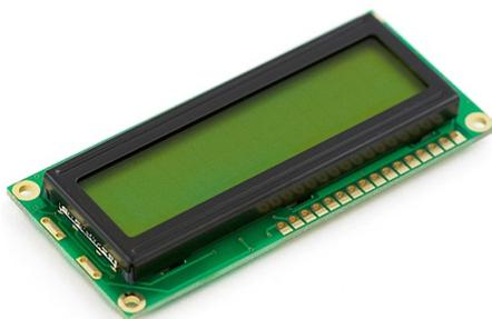
Figura 5 – Display LCD modelo JHD162a, responsável por fornecer *feedback* visual ao instrumentista.
