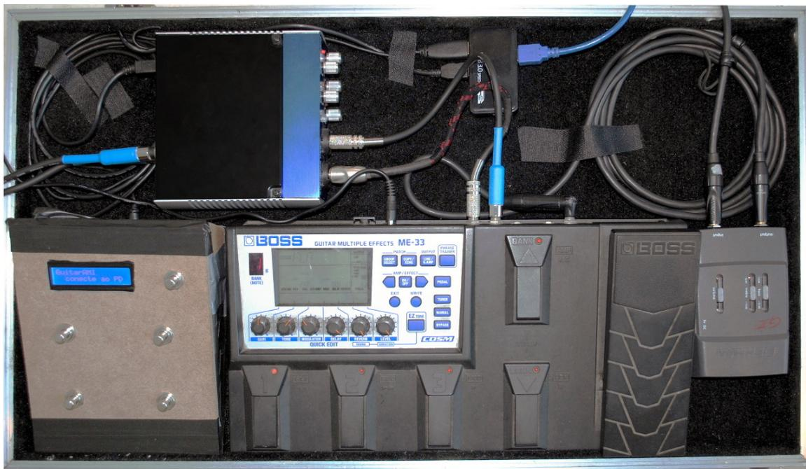
Figura 12 – *Pedalboard* montado com os componentes do terceiro protótipo do GuitarAMI e contendo a maior parte dos elementos do AMI. Um pedal de guitarra multi-efeitos foi também integrado ao *pedalboard*, conforme descrito na seção 2.8.0.3.
