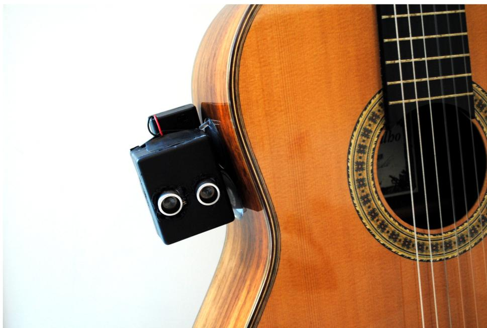
Figura 10 – Módulo utilizado no segundo e terceiro protótipos do GuitarAMI, utilizando conexão sem fio entre a base eo módulo e alimentado por pilhas recarregáveis.
