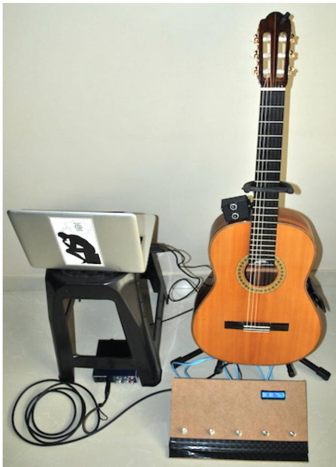
Figura 9 – Primeiro protótipo do GuitarAMI, construído utilizando Arduino Leonardo, sensor ultrassônico e acelerômetro (MENESES *et al.*, 2015a). O segundo protótipo é fisicamente semelhante ao primeiro, com exceção de que o módulo GuitarAMI foi convertido para se tornar sem fios, conforme descrito em 2.8.0.2.
