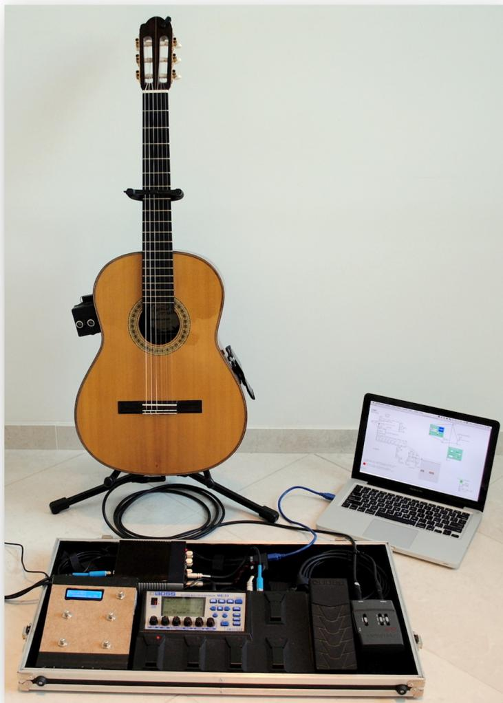
Figura 11 – Terceiro protótipo do GuitarAMI, utilizando conexão sem fio entre a base e o módulo, além da integração de um pedal de guitarra multi-efeitos.
