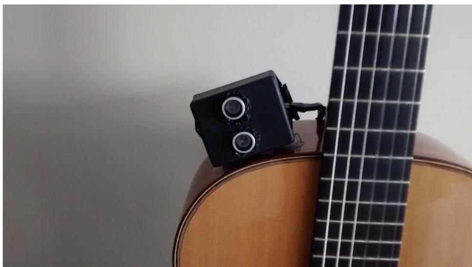
Figura 7 – Módulo do primeiro protótipo do GuitarAMI acoplado no instrumento. Este módulo possui o acelerômetro ADXL345 e o sensor ultrassônico HC-SR04 (MENESES *et al.*, 2015a).
