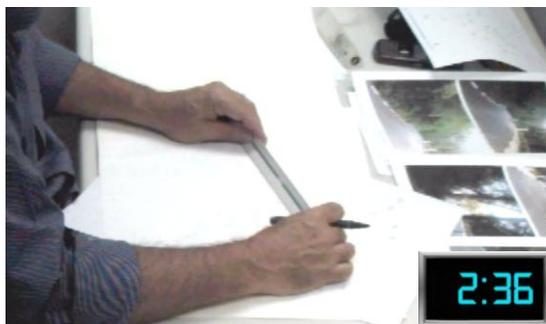
Figura AE1-2: Uso do escalímetro para realizar o corte
