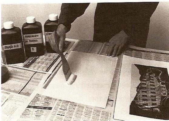
Figura 26. As soluções fotossensíveis deverão ser guardadas em frascos separados e de coloração escura para posterior mistura no momento da aplicação. Esta poderá ser feita com esponja, rolo de espuma ou trincha, conforme exemplificado na figura.
