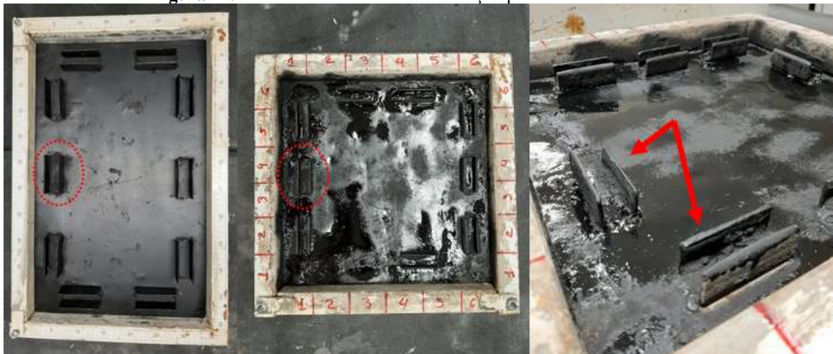
Figura 21. Fôrmas com o sistema de restrição para induzir as fissuras.
