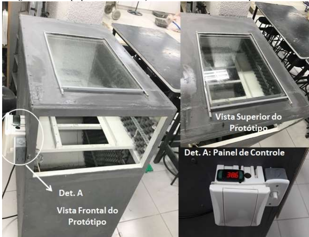
Figura 17. Protótipo para ensaio de retração – Detalhe A controle de temperatura e vento.
