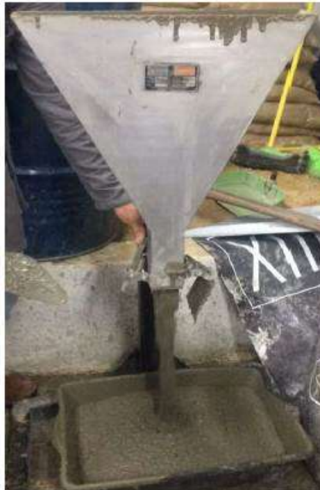
Figura 30. Determinação da viscosidade – Método do funil V.
