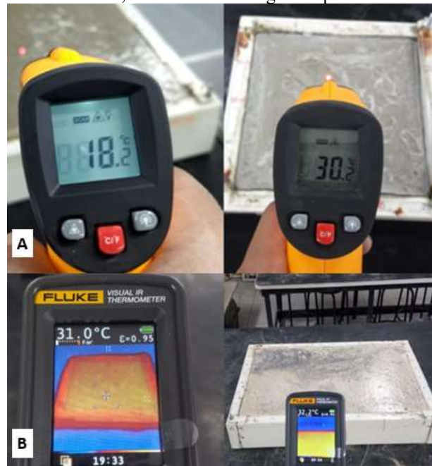
Figura 36. A - Termômetro a laser; B - Câmera termográfica para medir variação de temperatura
