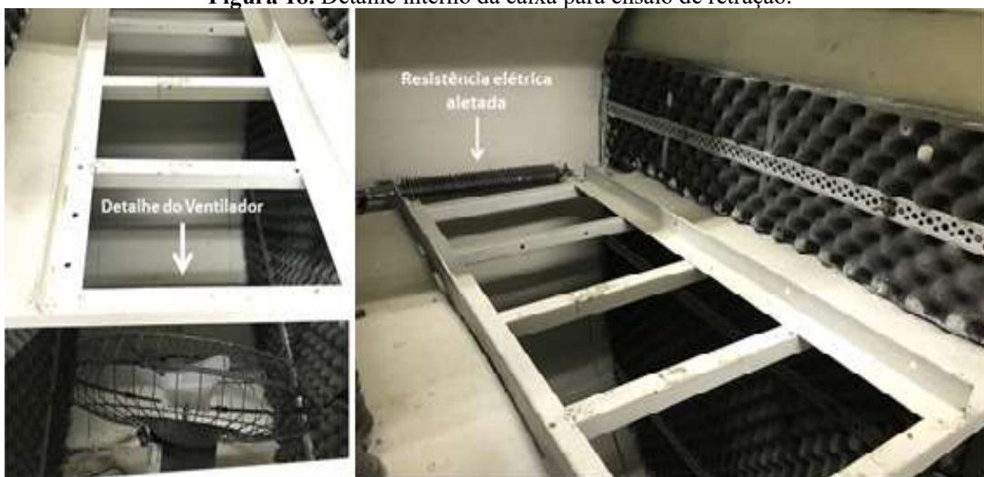
Figura 18. Detalhe interno da caixa para ensaio de retração.
