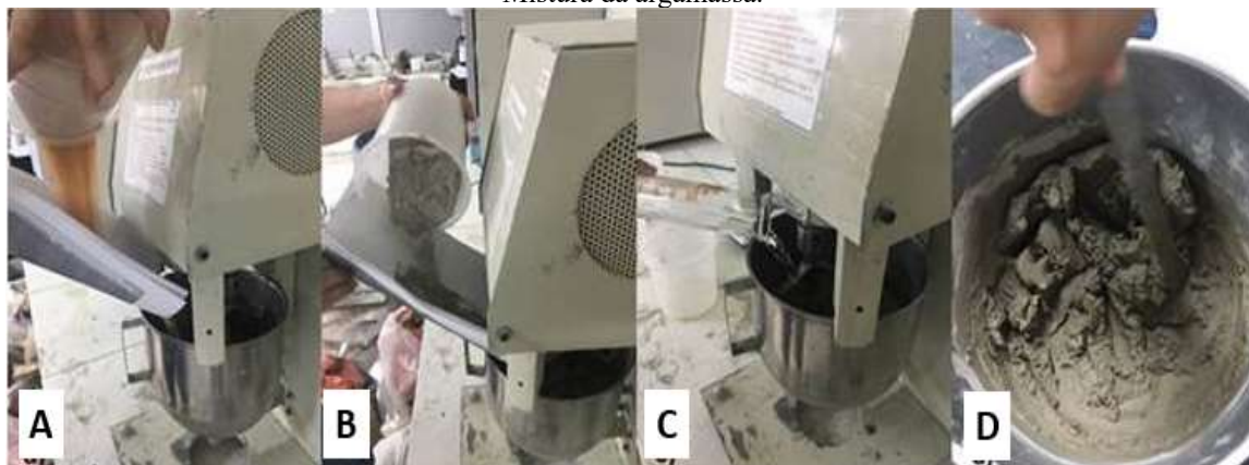
Figura 31. a) Adição agregados miúdos (areia + pó de brita); b) Adição do cimento; c) Adição da água; d) Mistura da argamassa.
