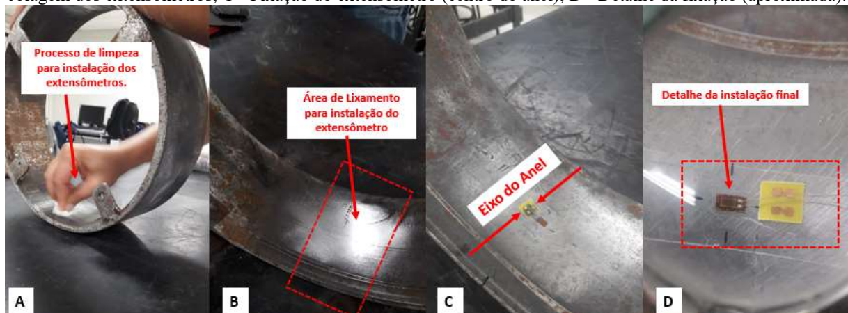
Figura 25. Metodologia para a instalação dos extensômetros; A - Processo de lixamento do anel; B - Área para colagem dos extensômetros; C - Fixação do extensômetro (centro do anel); D - Detalhe da fixação (aproximada).
