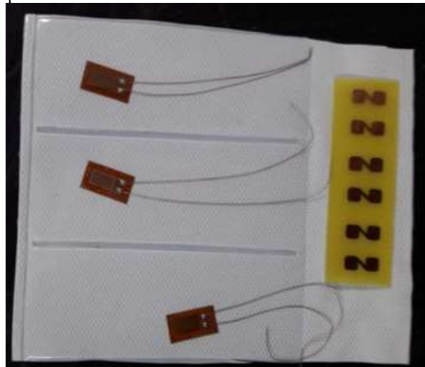
Figura 24. Exemplo dos extensômetros de 120\Omega com fio de cobre soldados e encapsulado.
