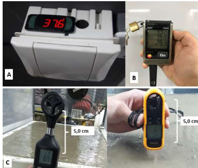
Figura 35. A - Termostato com controle de temperatura para ensaio da ASTM C 1579:13; B - Termômetro digital para verificação da temperatura e umidade relativa do ar externa; C - Anemômetro digital para medição da velocidade do vento.
