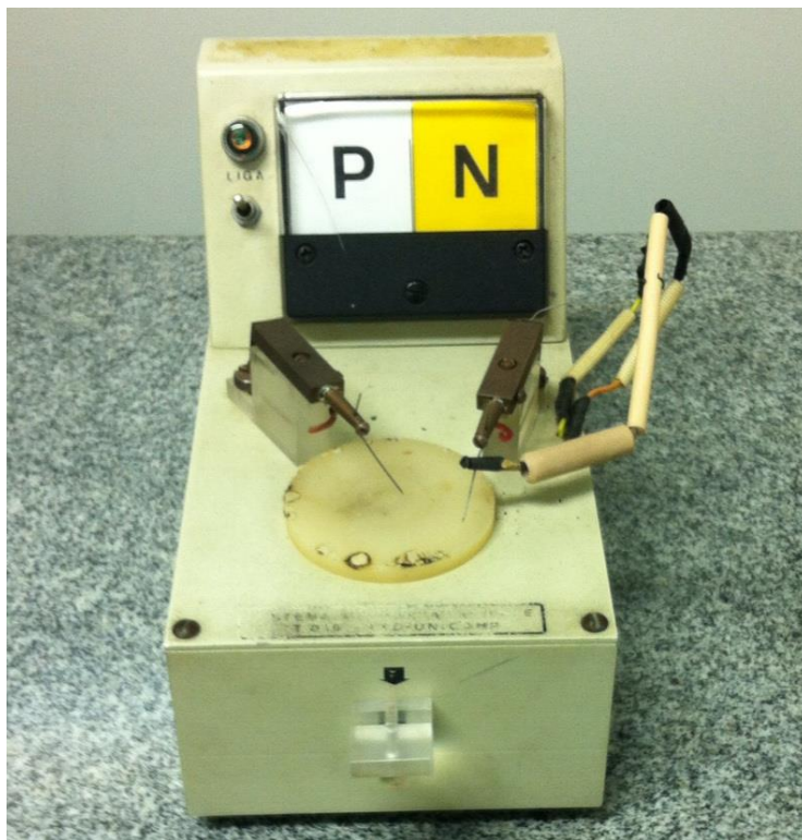
Figura 23: Medição da técnica conhecida como “ponta quente”.
