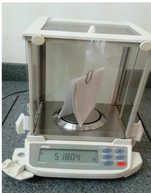
**Figura 9** - Filtro em balança analítica AND.
