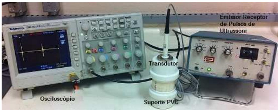
Fig. 5.2: Equipamentos utilizados no sistema de experimentação
