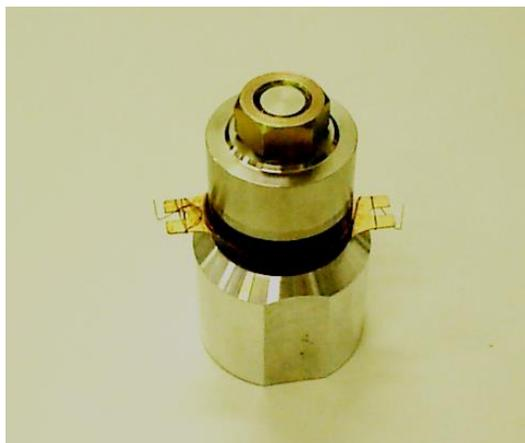
**Figura 3 - Transdutor piezelétrico do tipo sanduíche.**
