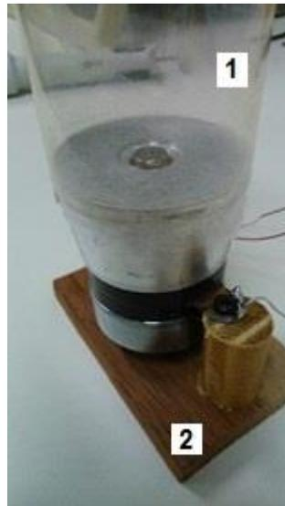
Figura 20 - Transdutor montado para aplicar água como carga.
