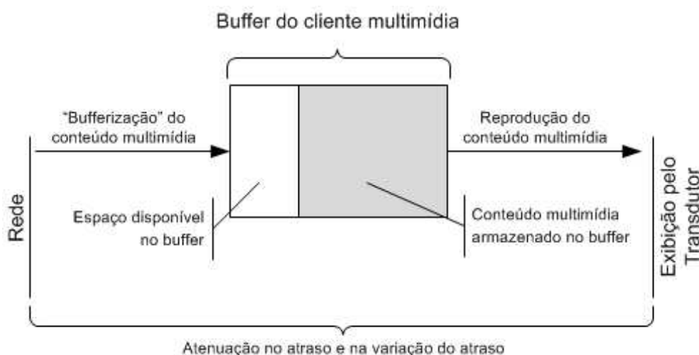
Figura 6 – Utilização de buffers para atenuação de atrasos (Adaptado de [23, 24]).
