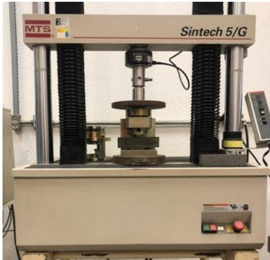
Figura 20: Ensaio de Tração na Flexão. Um corpo de prova sendo submetido a uma carga perpendicular no meio do vão, causando a ruptura.
