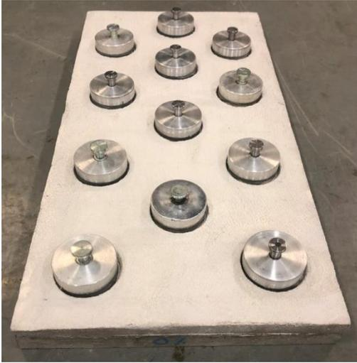
Figura 30: Execução do ensaio de aderência à tração.
