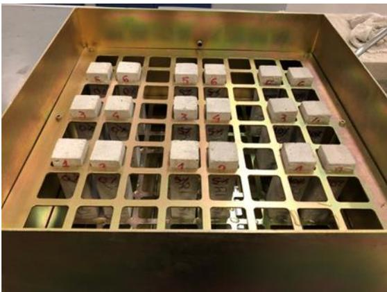
Figura 24: Corpos de provas após ensaio de capilaridade.
