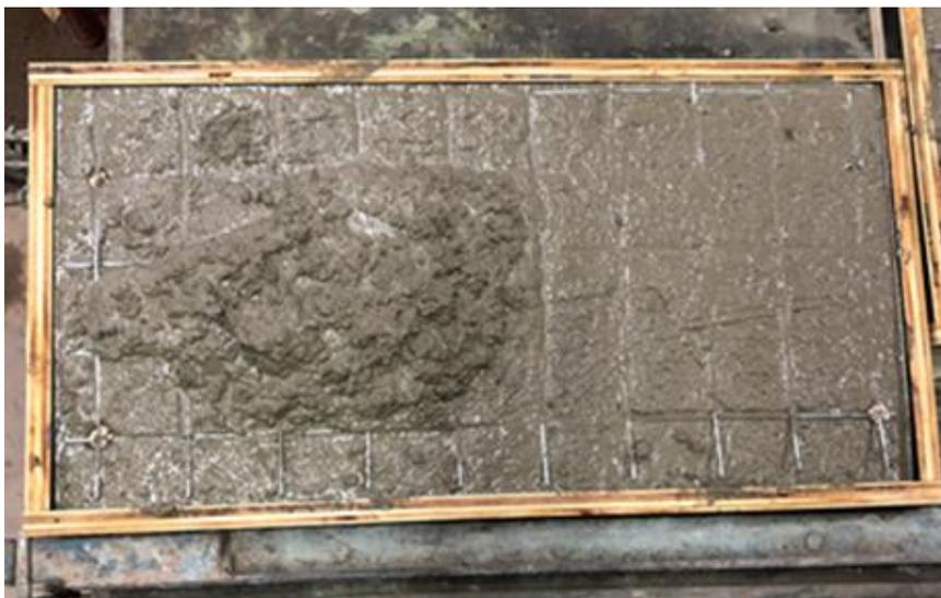
Figura 26: Substrato padrão após cura de 28 dias.
