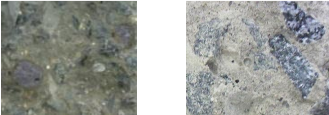
Figura 2.12: Ilustração da ruptura à compressão nos concretos com argila expandida brasileira (à esquerda) e com agregado de basalto (à direita).
