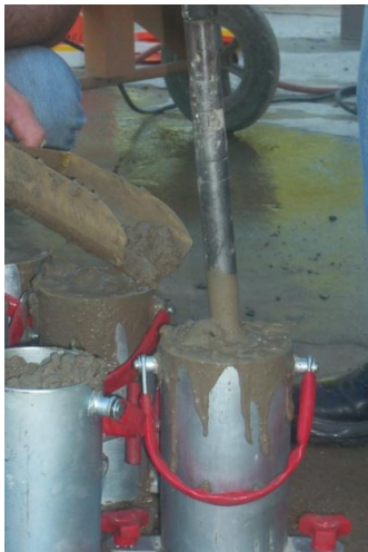
Figura 5.15: Adensamento mecânico dos corpos-de-prova cilíndricos de 100 mm de diâmetro e 200 mm de altura.
