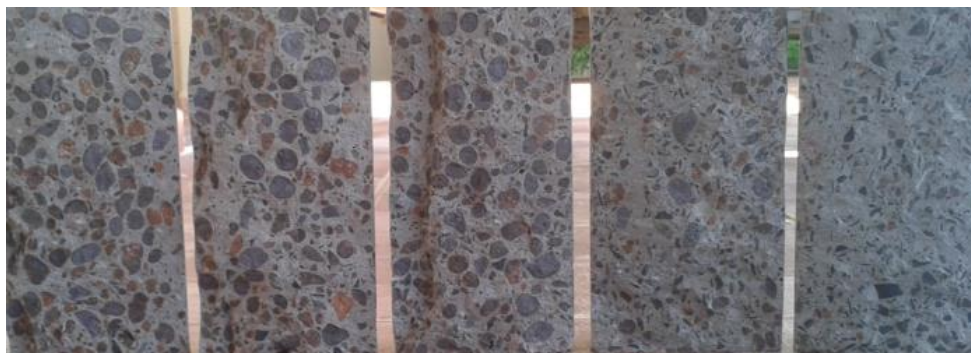
Figura 6.8: Corpos-de-prova após a ruptura por tração diametral.
