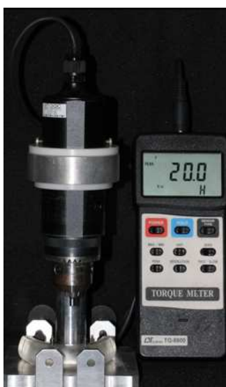
Figura 8. Torqu metro digital posicionado em uma base estabilizadora para torque dos attachments .
