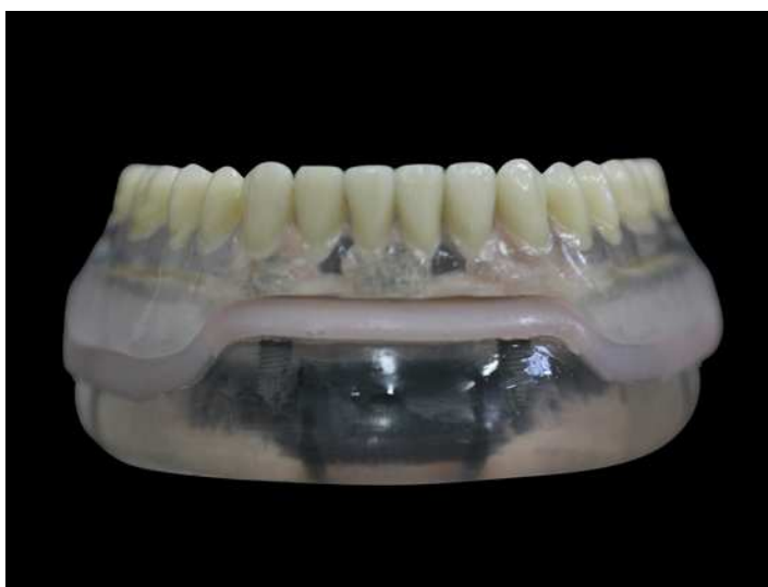
Figura 9. Overdenture em posição no modelo fotoelástico após a captura dos attachments .
