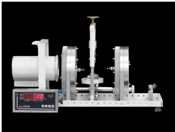
Figura 11. Vista lateral do polariscópio de transmissão circular.
