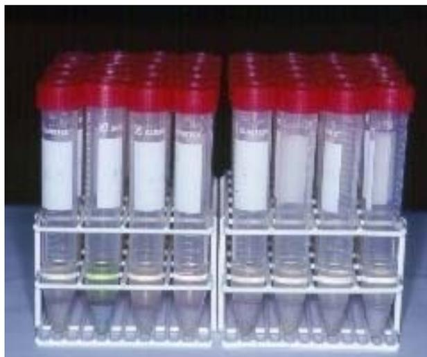
Figura 15- Amostras trituradas e submersas em álcool para solubilização do corante.
