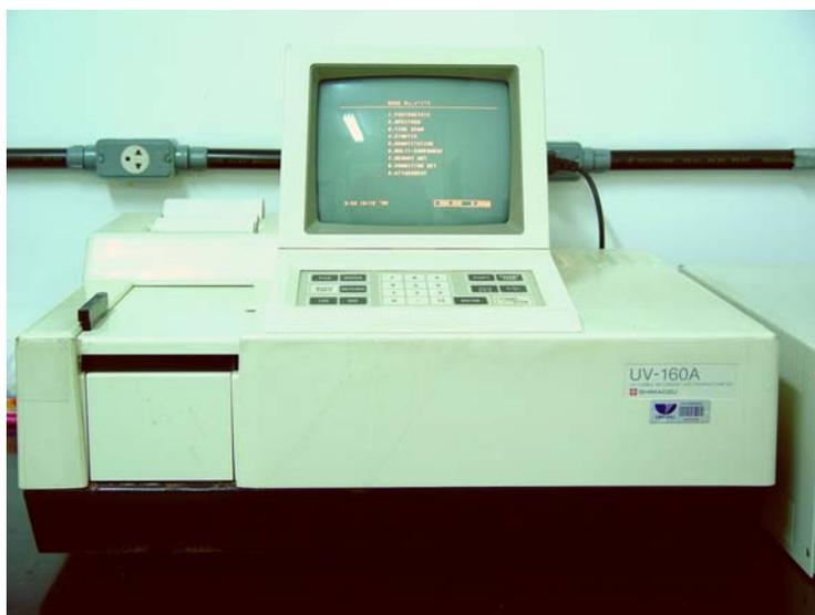
Figura 14- Espectrofotômetro empregado para obtenção das leituras em absorbância.
