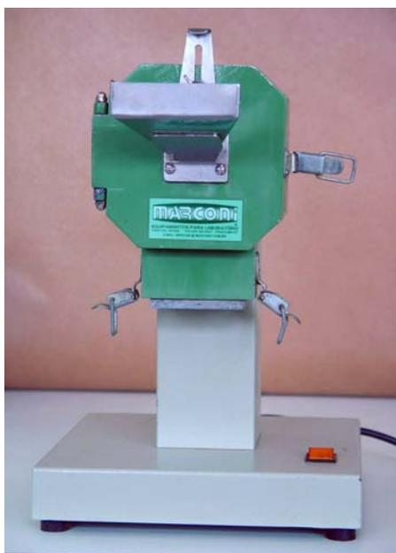
Figura 11 - Moinho marca Marconi utilizado para a moagem das amostras.
