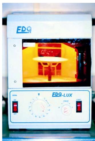
*Fig. 4.5: Unidade polimerizadora
