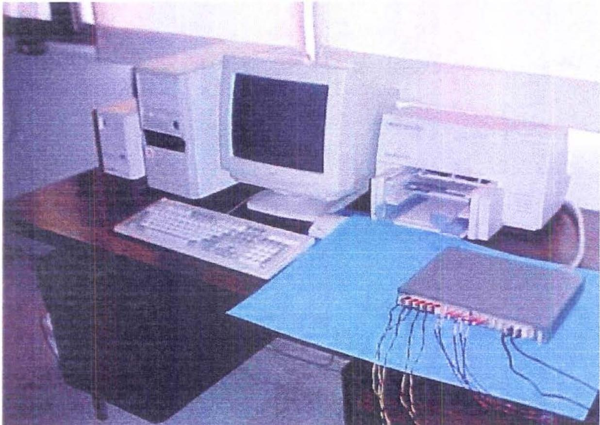
**Figura 2.** Conversor Analógico-Digital A/D (CAD 12/36 – 60 K) - LYNX Tecnologia Eletrônica Ltda de 16 canais e Programa de Aquisição de Dados (Aqdados versão 4.6), interfaciado com um computador 486 DX, do Laboratório de Eletromiografia do Departamento de Morfologia da Faculdade de Odontologia de Piracicaba – FOP / UNICAMP.
