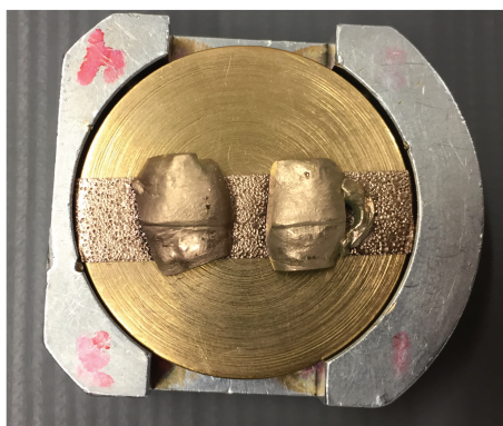
Figura 5 Amostras metalizadas com ouro-paládio.
