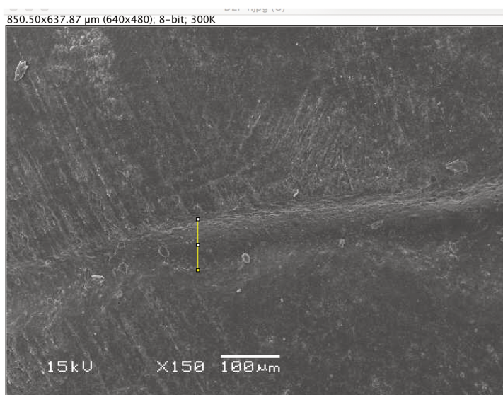
Figura 7 Mensuração da linha de cimentação (adaptação marginal).
