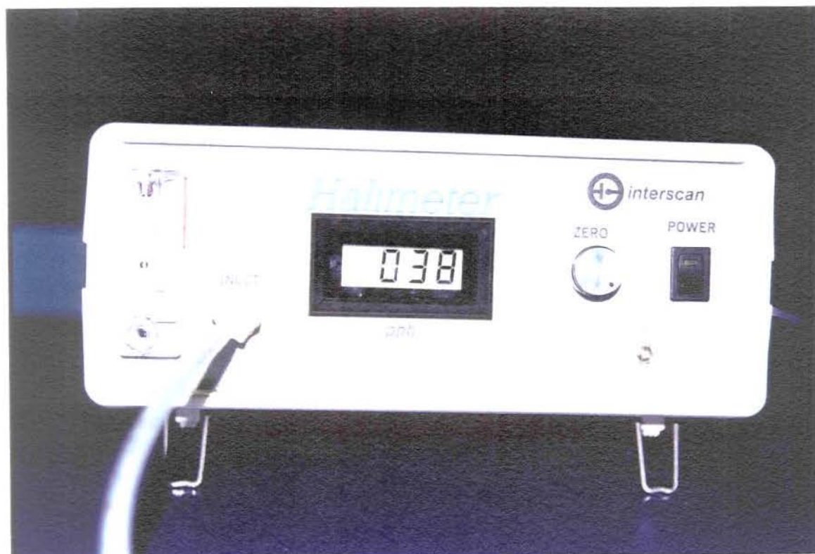
FIG.7: Monitor de sulfetos industrial portátil utilizado para quantificação dos CSV no DIA 0 e DIA 21 de cada período experimental de 21 dias.
