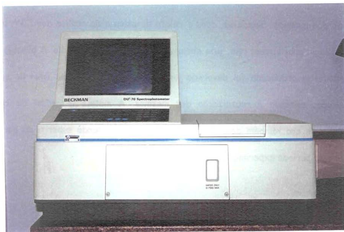
FIG.13: Espectrofotômetro utilizado para detecção da reação colorimétrica (OD 405) obtida com o substrato BAPNA nas amostras de placa dental dos voluntários.
