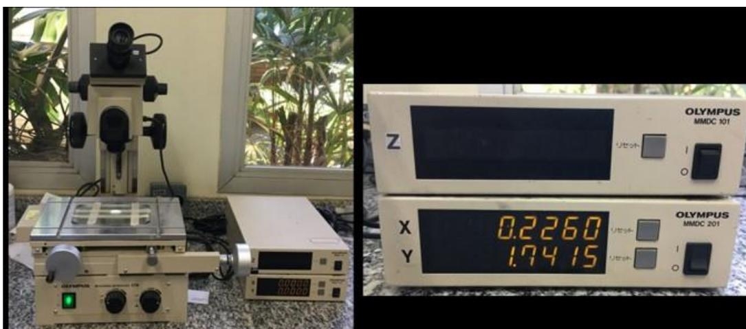
Figura 16 – À esquerda, microscópio comparador, e à direita o dispositivo para a criação dos eixos X, Y e Z, no plano cartesiano.
