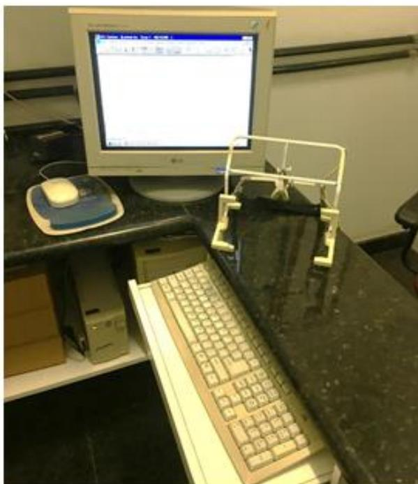
Figura 9 – K6-I Diagnostic System. Sobre a bancada, o arco com sensores eletromagnéticos que rastreiam os movimentos do magneto.
