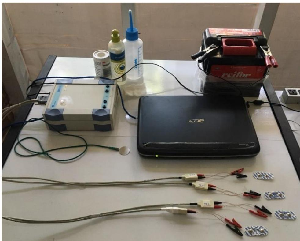
Figura 13 – Eletromiógrafo ADS1200 Lynx. Foram utilizados eletrodos de superfície bipolares Ag/AgCl 200 com pré-amplificadores individuais.
