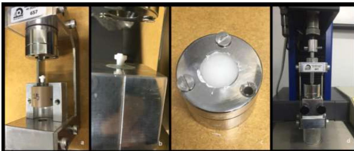
Figura 13 – Posicionamento dos conjuntos para ensaio de Pull out .
