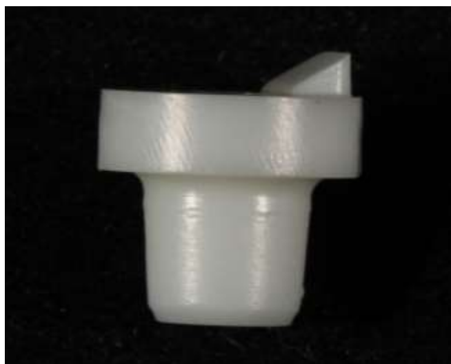
Figura 2 – Corpo de prova com formato simplificado de coroa
