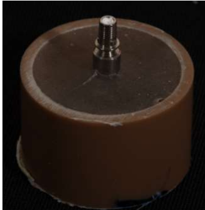
Figura 8 – Pilar sobre réplica de implante posicionado na base e orifício oclusal preenchido por fita de teflon
