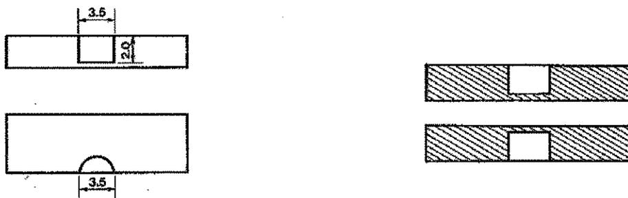
**FIGURA 7.** Desenho esquemático das dimensões obtidas após separação das peças (esquerda), observando-se o plano de corte com o qual as peças foram incluídas em parafina (direita)
