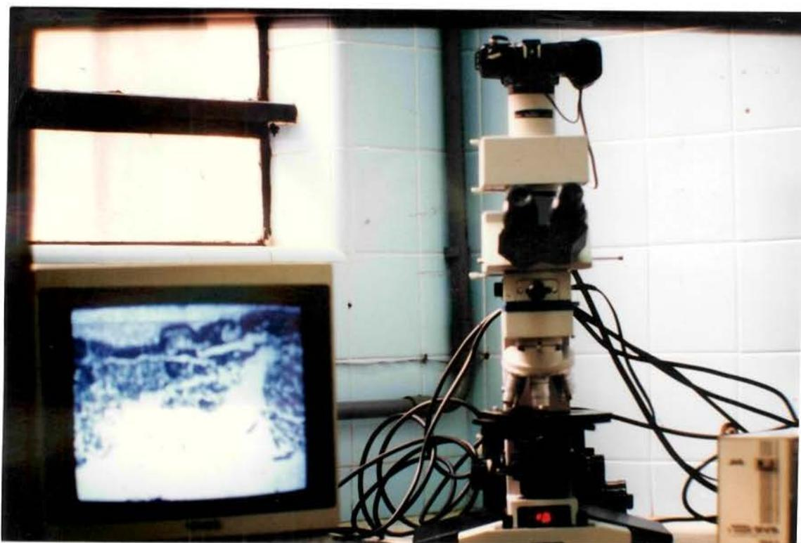
FIGURA 8. Fotografia do microscópio óptico acoplado à microcâmera e estes ao monitor de vídeo.
