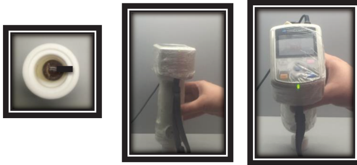
Medições finais de cor da pintura de íris através do espectrofotômetro de reflexão
