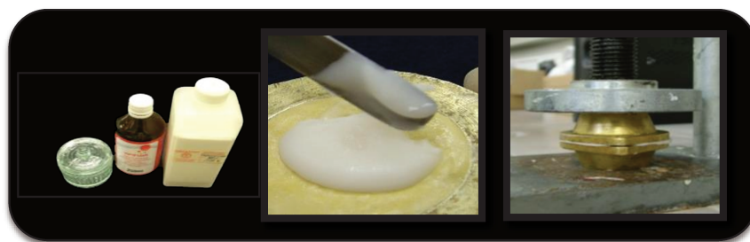
Inclusão da resina acrílica e prensagem
