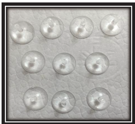
Despolimento das calotas com lixas de granulação 120 e 200 em Politriz
