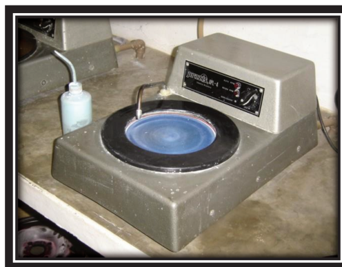
Despolimento das calotas com lixas de granulação 120 e 200 em Politriz
