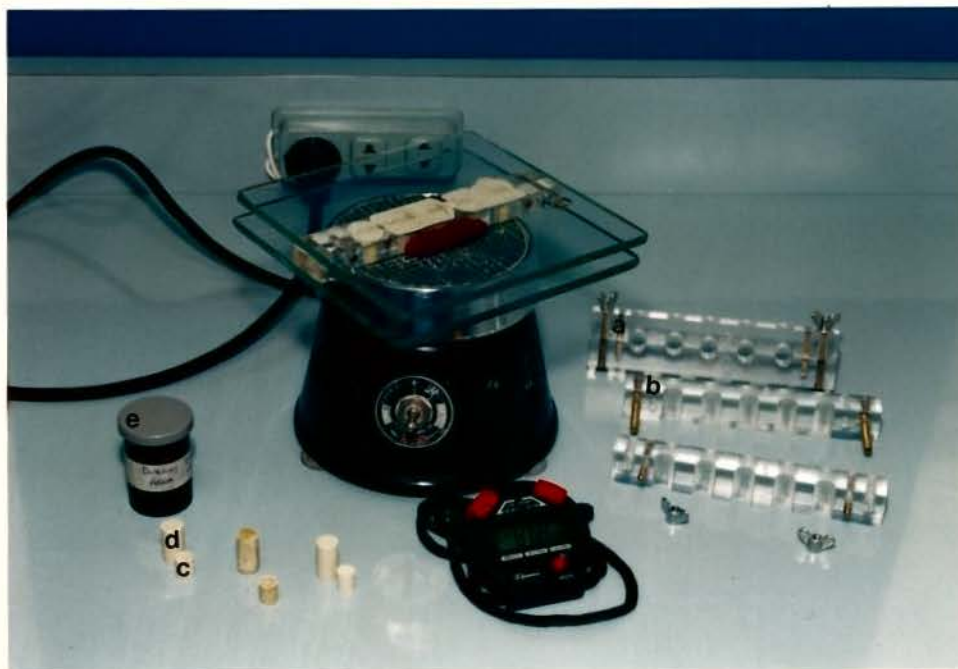
Figura 4 - Material e dispositivos utilizados na confecção das amostras para os testes de resistência à abrasão, dureza e resistência à compressão.
