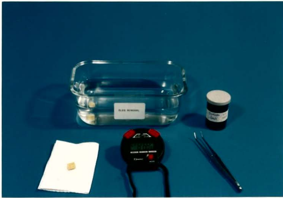
Figura 5 - Amostras imersas em óleo mineral para os testes de resistência à abrasão e dureza.
