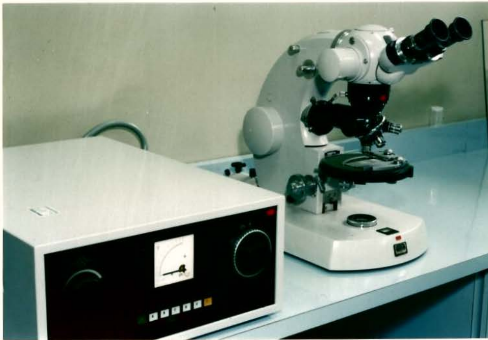
Figura 10 - Fotomicroscópio para observação e fotografia dos cristais.
