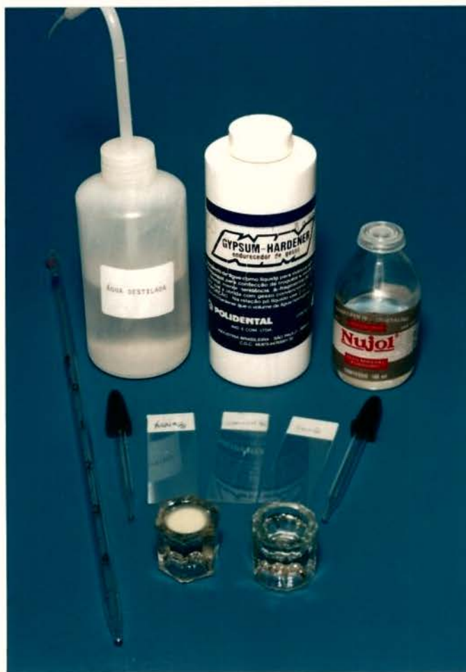
Figura 9 - Materiais utilizados na confecção das amostras para observação dos cristais.
