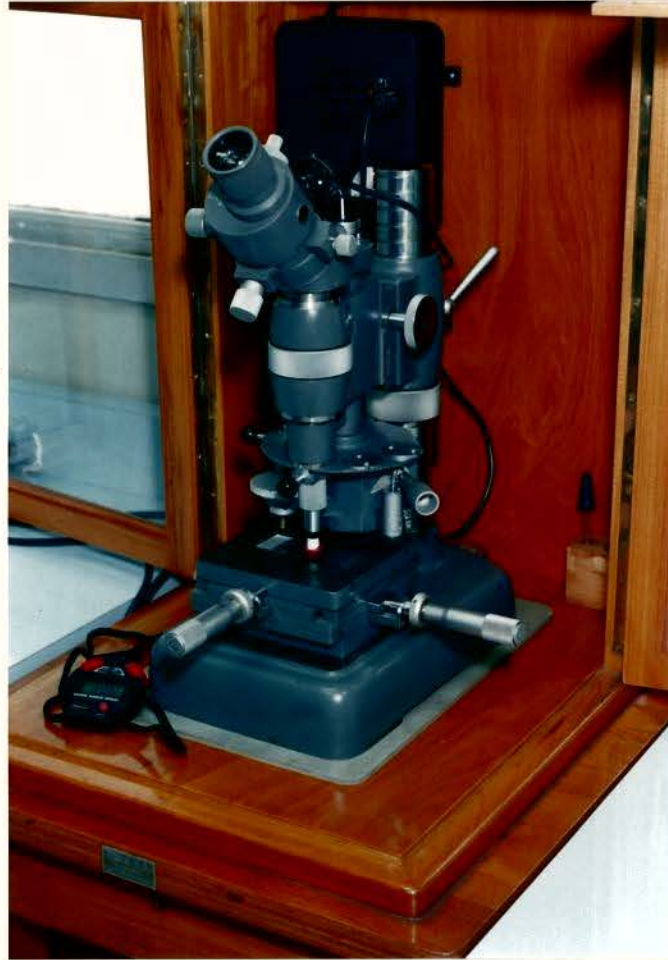
Figura 7 - Aparelho para ensaio de dureza.
