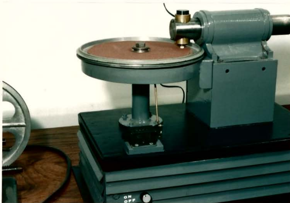
Figura 6 - Máquina para ensaio de abrasão.
