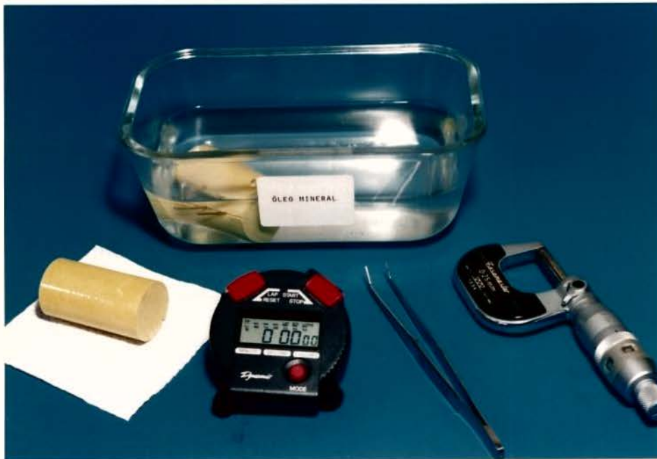
Figura 3 - Amostras imersas em óleo mineral para os testes de alteração dimensional de presa.
