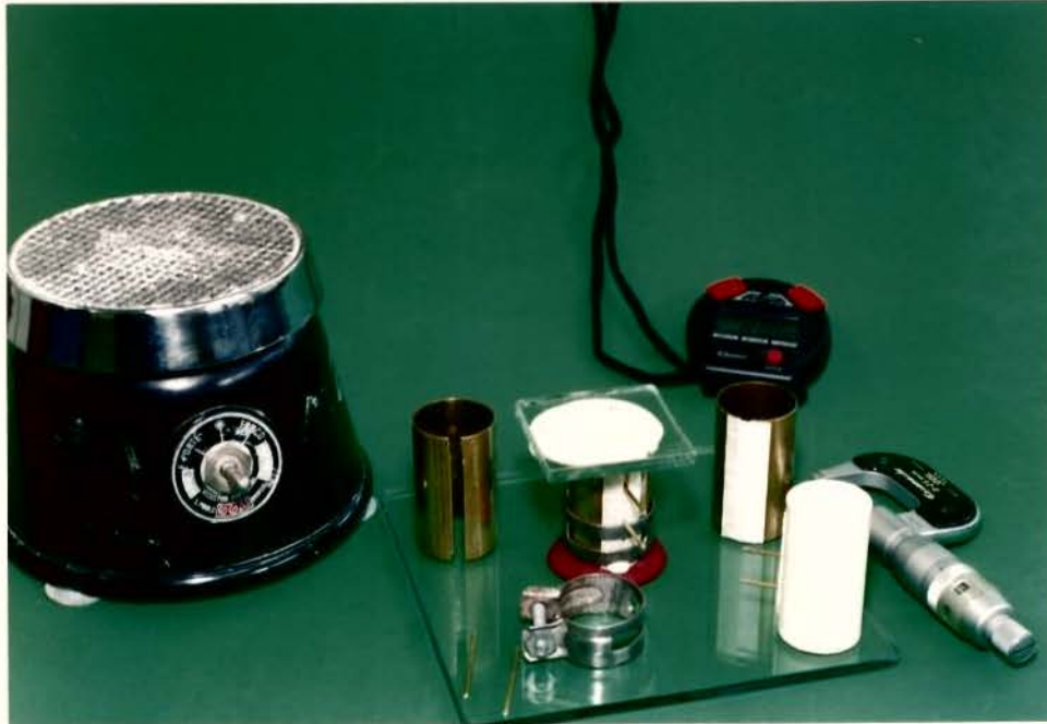
Figura 2 - Material e dispositivos utilizados na confecção das amostras para o teste de alteração dimensional de presa.
