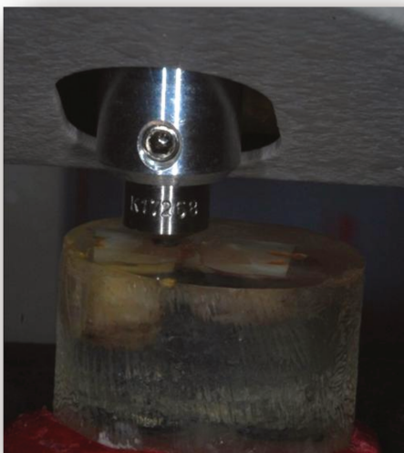
Figura 23: Ensaio de microdureza Knoop com 3 identações em 3 níveis de profundidade.
