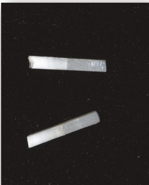
Figura 18: Obtenção de palitos com 0,9x0,9 mm
