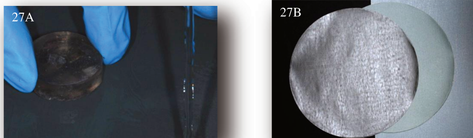
Figura 27: Desgaste das amostras com lixas d'água em politriz. 27A: posicionamento da amostra na politriz. 27B: seqüência das lixas utilizadas (600, 1200 e 2000).
