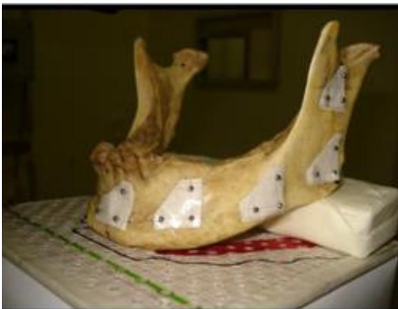
Figura 14-Mandíbula posicionada sobre o *phantom* com os triângulos na cortical externa
