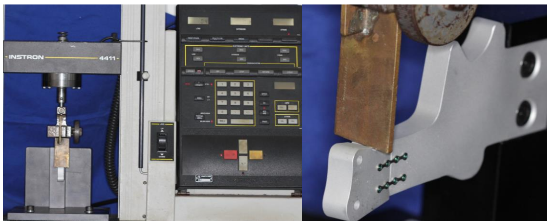
Figura 3. Incidência da carga axial no sulco em região anterior do modelo mandibular de Alumínio.
