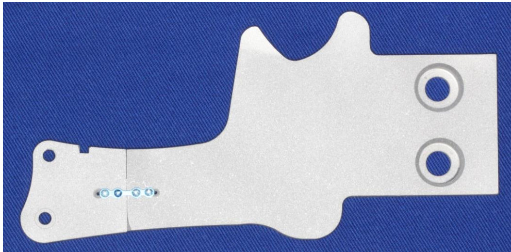
Figura 4. Hemimandíbula com uma placa reta de quatro furos do sistema 1,5mm na zona neutra da marca Traumecc®.
